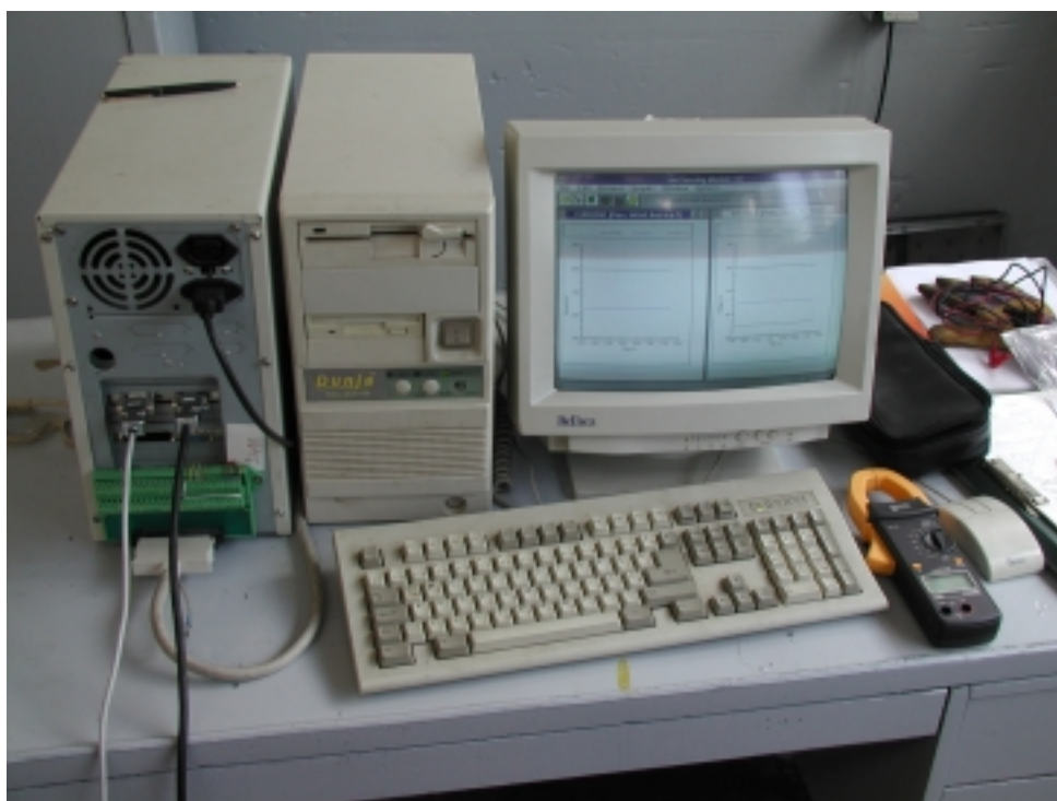
Slika 9. On-line monitoring sustav pri registraciji parametara zavarivanja praškom punjenom žicom
