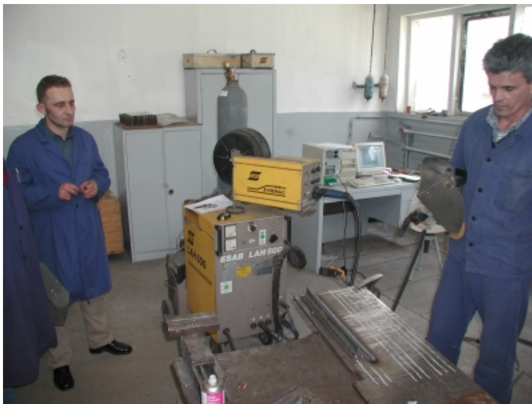
Slika 4. Detalj kod provođenja eksperimentalnog navarivanja praškom punjenom i punom žicom MAG postupkom.
