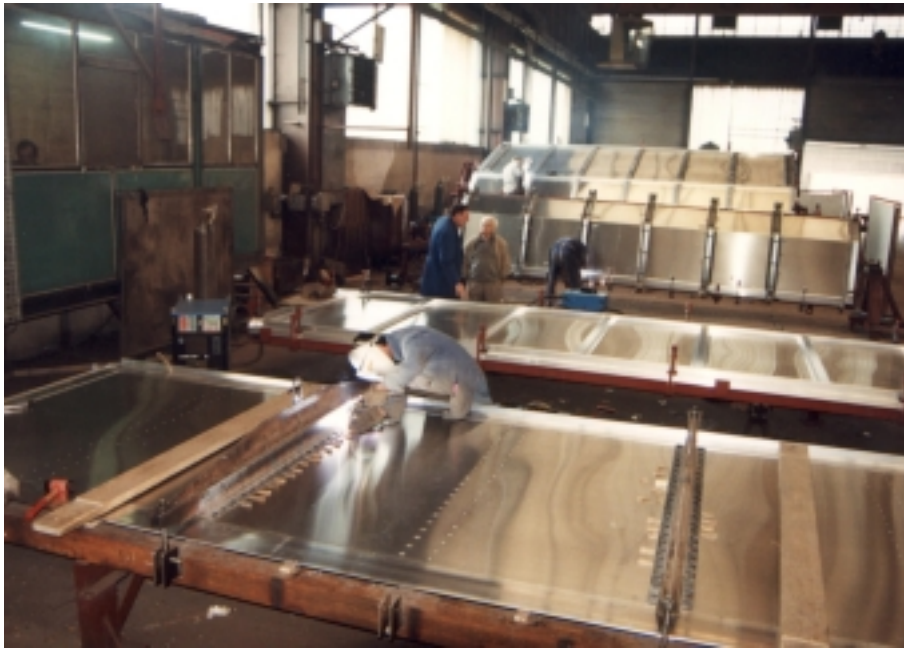
Slika 2. Detalj spajanja limova i profila od Al-legura zavarivanjem u provrtu.
