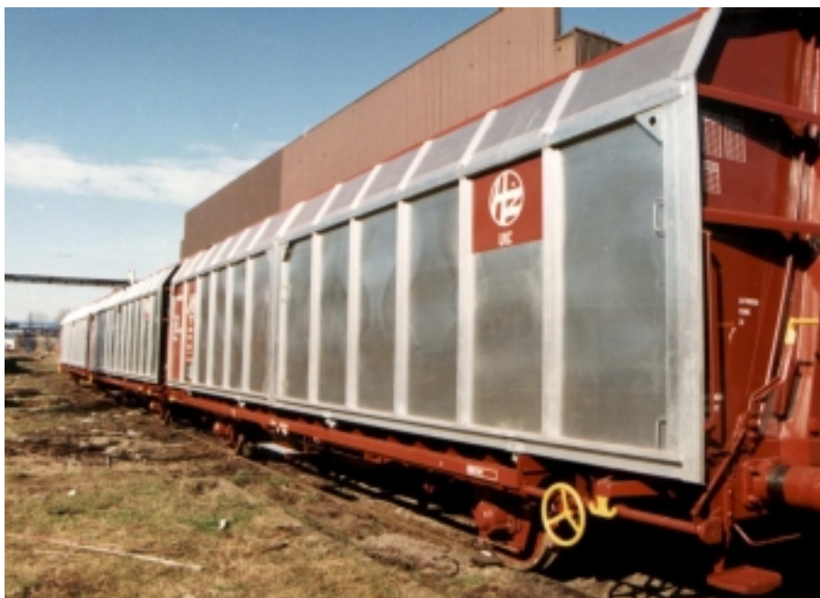
Slika 1. Novi Hbills vagon sa lakom konstrukcijom vrata od Al-legura.
