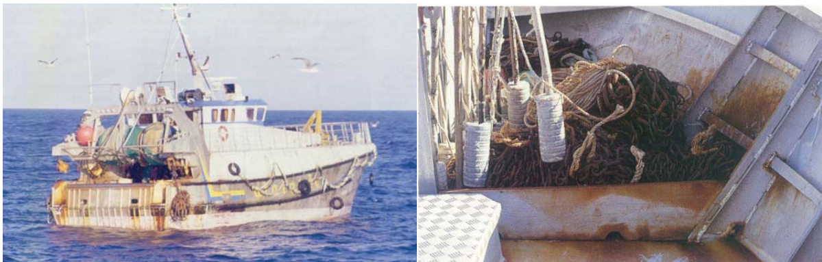
Slika 2.2.1 Kočarica od Al legure, već xx godina u upotrebi bez ikakve površinske zaštite.
