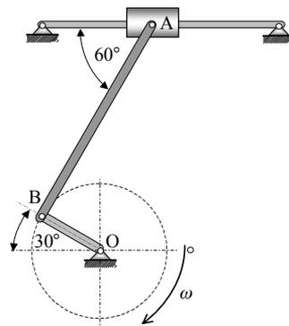
4.4.34 Za mehanizam, na slici poznato je da kutna brzina iznosi  $\omega = 4 \text{ rad/s} = \text{konst}$ . Potrebno je odrediti brzinu **klizača C** i kutnu brzinu štapa AC.
