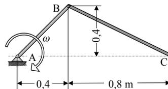
4.4.32 Za mehanizam, na slici poznato je da u prikazanom položaju brzina štapa B iznosi  $\vec{v}_B = -12,7\vec{j}$  (dakle prema dolje  $12,7 \text{ cm/s}$ ). Potrebno je odrediti **brzinu točke A** i kutnu brzinu štapa AB.
