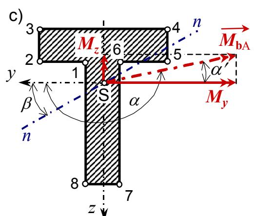
Kut vektora rezultirajućeg momenta savijanja  $\vec{M}_{bA}$  s težišnom osi  $y$  poprečnog presjeka:
