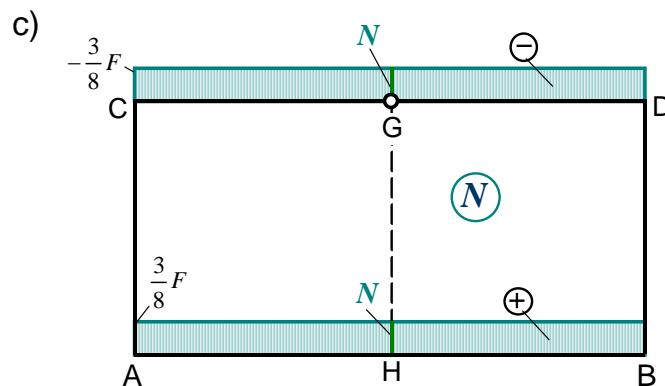
Dijagram unutarnjih poprečnih sila duž konture zatvorenog zglobovnog okvirnog nosača:
