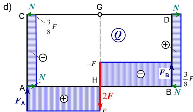
Momenti savijanja u karakterističnim točkama zatvorenog zglobovnog okvirnog nosača jesu:
