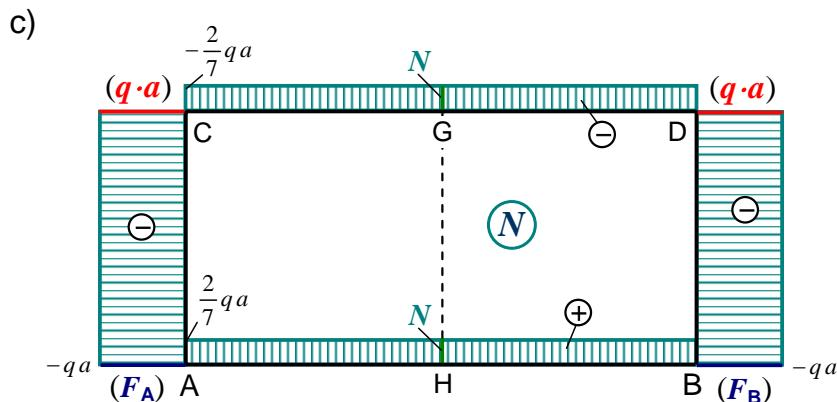
Dijagram unutarnjih poprečnih sila duž konture zatvorenog okvirnog nosača:
