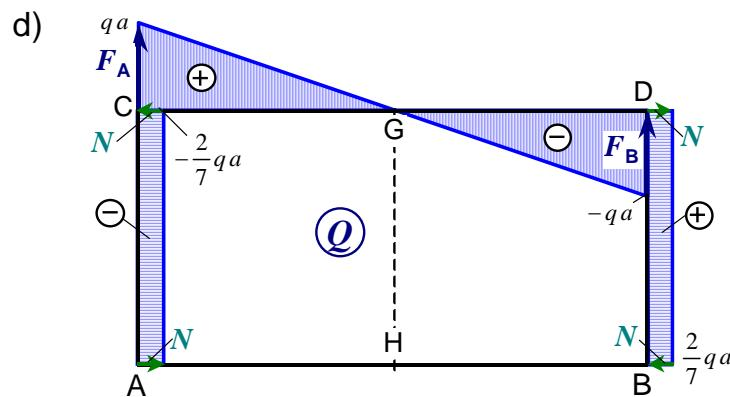
Momenti savijanja u karakterističnim točkama zatvorenog okvirnog nosača jesu:
