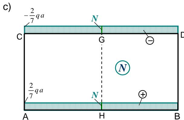
Dijagram unutarnjih poprečnih sila duž konture zatvorenog okvirnog nosača:
