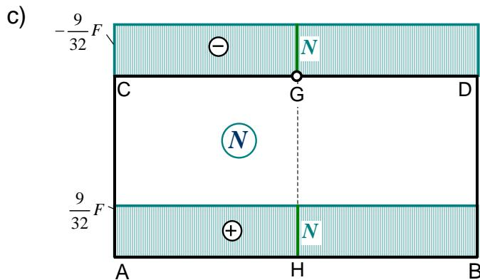
Dijagram unutarnjih poprečnih sila duž konture zatvorenog zglobnog okvirnog nosača:
