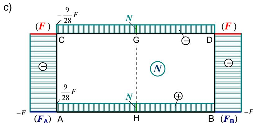
Dijagram unutarnjih poprečnih sila duž konture zatvorenog okvirnog nosača:
