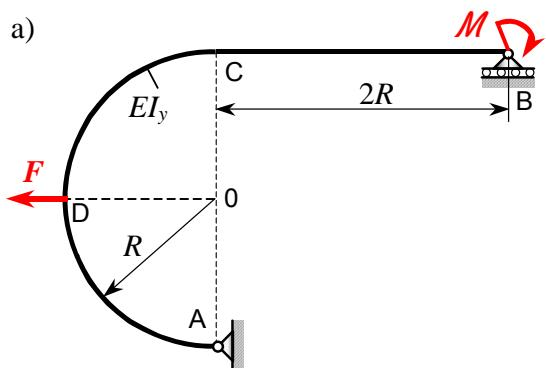
Za statički određeni okvirni nosač zadan i opterećen prema slici a) treba:
