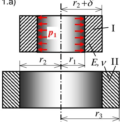
Sastavljena debela cijev sastoji se od unutarnje cijevi (I) polumjera  $r_1$  i  $r_2$ , te vanjske cijevi (II) polumjera  $r_2$  i  $r_3$ , slika 1.a). Cijev je opterećena jednolikim unutarnjim tlakom  $p_1$ . Tlak na sastavu cijevi je  $p_d$  (nakon prisilnog sastavljanja, a prije opterećivanja cijevi), slika 1.b).
