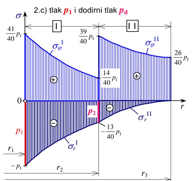
Iz tablice i slike 2.c) vidi se, da su se u sastavljenoj debeloj cijevi vrijednosti cirkularnih naprezanja smanjile u unutarnjoj cijevi, ali su se povećale u vanjskoj cijevi u odnosu na vrijednosti cirkularnih naprezanja u cijevi iz jednog dijela (slika 2.b), kod jednakog unutarnjeg tlaka  $p_1$  u cijevi.
