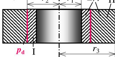
1. vrijednosti radikalnih i cirkularnih naprezanja  $\sigma_r$  i  $\sigma_\varphi$ , uz skice raspodjele naprezanja po presjeku cijevi i to:
