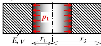
2. dopuštenu vrijednost unutarnjeg tlaka  $p_{1\text{dop}}$  sastavljenе cijevi prema teoriji najvećeg posmičnog naprezanja  $\tau_{\max}$ , ako je dopušteno naprezanje materijala:  $\sigma_{\text{dop}} = 340 \text{ MPa}$ ,
