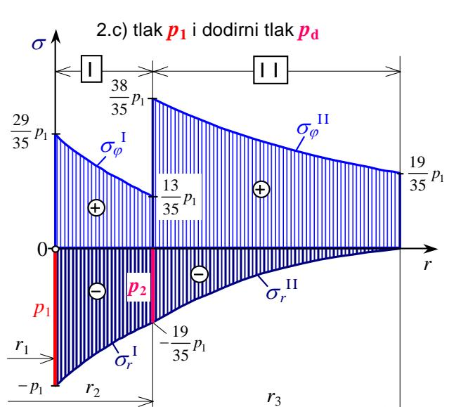
Iz tablice i slike 2.c) vidi se, da su se u sastavljenoj debeloj cijevi vrijednosti cirkularnih naprezanja smanjile u unutarnjoj cijevi, ali su se povećale u vanjskoj cijevi u odnosu na vrijednosti cirkularnih naprezanja u cijevi iz jednog dijela (slika 2.b), kod jednakog unutarnjeg tlaka  $p_1$  u cijevi.
