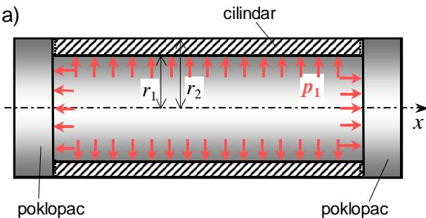
Za čeličnu zatvorenu debelostjenu posudu prema slici a), opterećenu unutarnjim tlakom  $p_1 = 500$  bar, treba:
